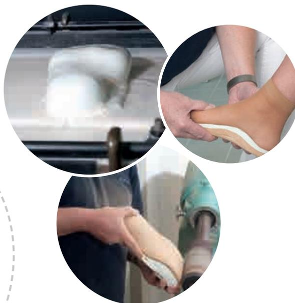
**5.** Im nächsten Schritt formt die Tiefziehmaschine den Schaum, wobei eine Silikon-Membran bei starkem Unterdruck um das Gipsmodell gespannt wird und so die einzelnen Schichten ganz eng an Elkes Modellfuß presst. Jedes Detail des Fußes wird so ganz genau abgebildet. Damit die Sohle passgenau in den Schuh gleitet, muss sie von der geübten Hand des Technikers filigran auf die Brandsohlenform des Schuhs zugeschliffen werden.
