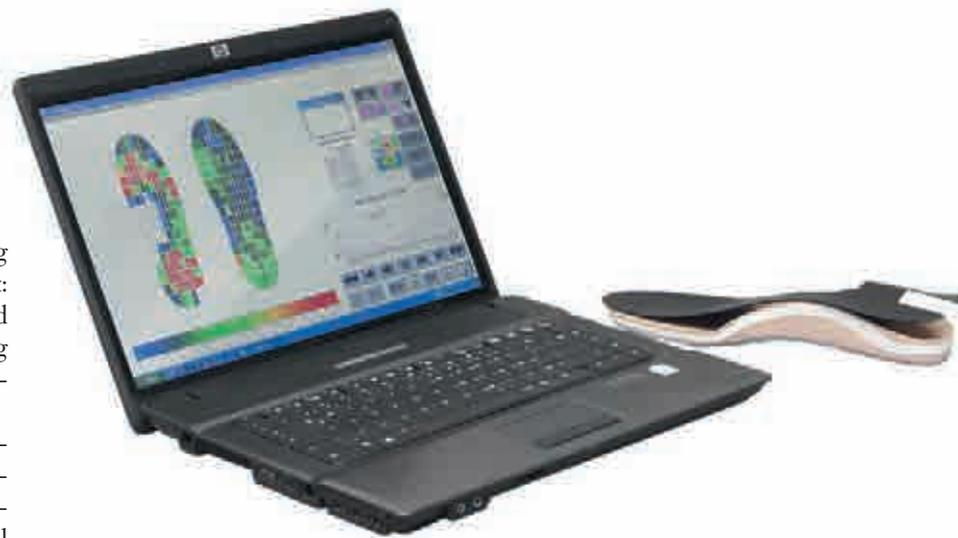
**6.** Zum Schluss wird die fertige Fußbettung in einem High-Tech-Verfahren geprüft: Eine spezielle Sohle mit Drucksensoren wird über die fertige Einlage gelegt. Frau Altenberg schlüpft in ihren speziellen Schuh und die Druckverteilung wird nachgemessen. So soll es sein: Das Gewicht ist gleichmäßig verteilt, ein guter Schutz vor Blasen und Druckstellen. Nun kann Elke Altenberg wieder unbeschwert laufen: Tschüss, Frau Altenberg, viel Spaß beim Wandern!
